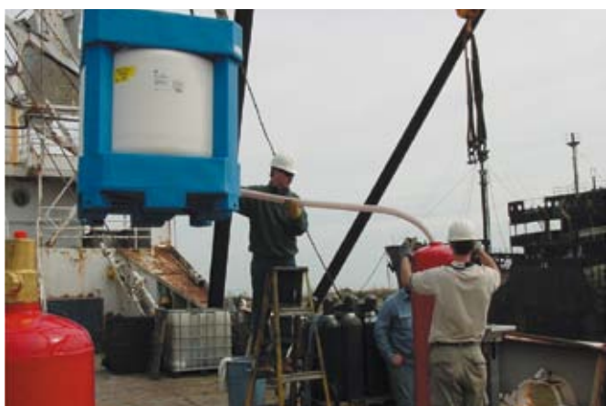
Операция по заправке модуля 3M™ Novec™ 1230
